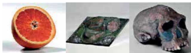
Figura 16. Mcor's 3D print: Naranja, Mapa y Calavera después del desbastado. (MacCormack, 2013)
