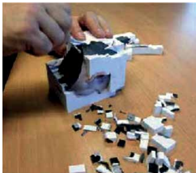
Figura 15. Impresión 3D de Mcor's: eliminando el material. (Mcors, 2013)
