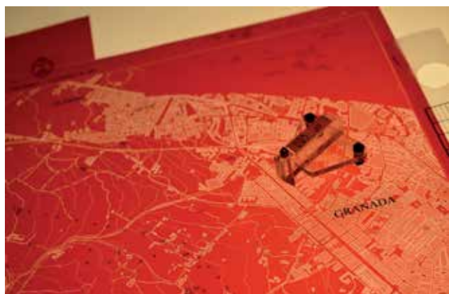
Figura 2. Hoja de «stabilene» con el cangrejo usado para el esgrafiado de las curvas de nivel
