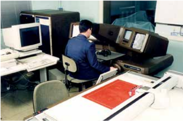
Figura 3. Avioflyt AC1 con mesa trazadora TA2 esgrafiando hoja de stabilene
