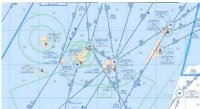
Figura 9. Carta de navegación instrumental 1:2.000.000 del CECAF. Observe que la información geográfica representada se limita al contorno de la costa.
