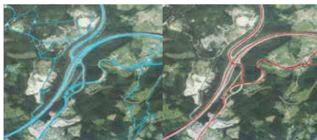
Figura 4. A la izquierda, en azul, tramos de carretera disponibles en IGR-RT para una zona determinada; a la derecha, en rojo, tramos seleccionados sobre los cuales se realizó el proceso de referenciación lineal
