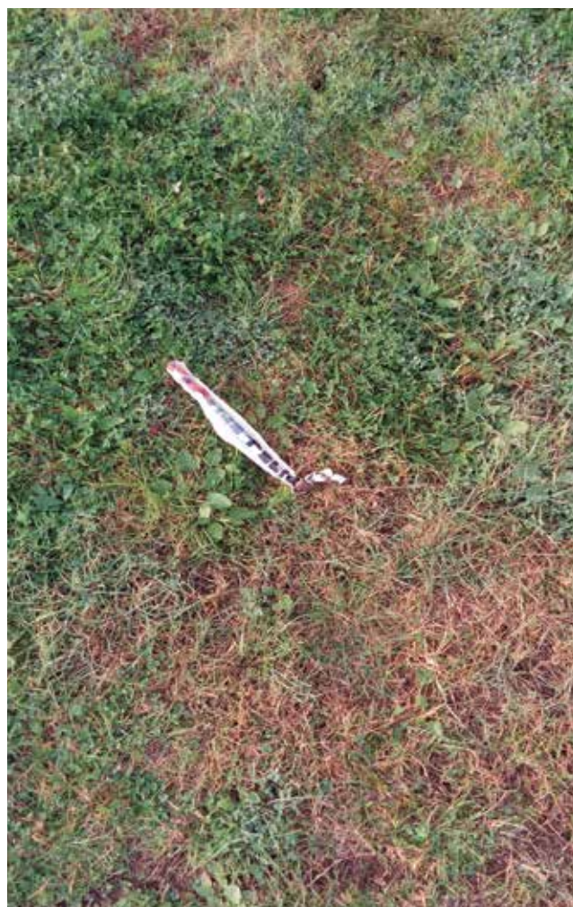
Figura 2. Puntos en el terreno materializados con estacas de hierro.
