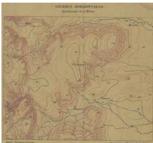
Figura 3. Dibujo de la misma parte de la hoja de Clermont 1:40.000, con la altimetría por curvas de nivel.
