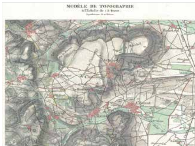
Figura 2. Dibujo de una parte de la hoja de Clermont a escala 1:40.000 con representación del relieve con el sistema de normales.
