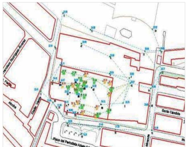
Figura 9. Red de Control Métrico (RCM).
