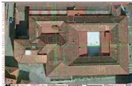
Figura 27 Planta de cubiertas sobre distribución de muros y espacios de la segunda planta.
