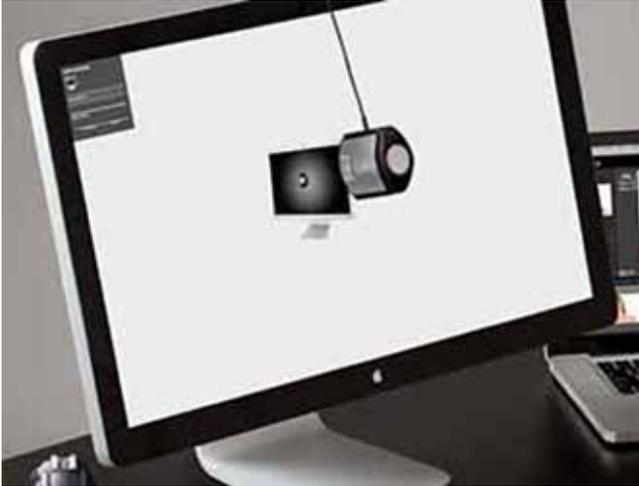
Figura 8: dispositivo de calibración y perfilado (<https://www.xrite.com>)
