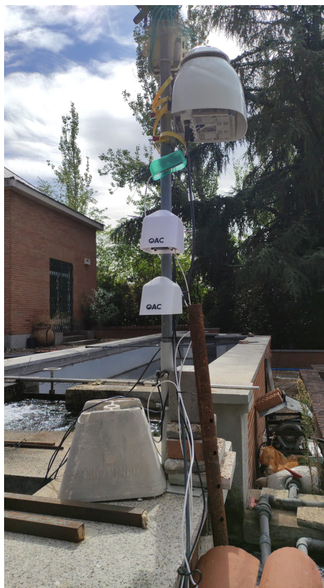
Figura 8. Sensores de NO 2 de bajo coste instalados en la Escuela Técnica Superior de Ingeniería de Montes, Forestal y del Medio Natural, Universidad Politécnica de Madrid.
