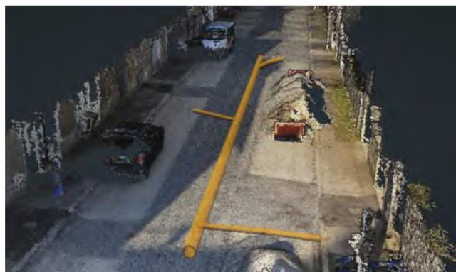
Colector digitalizado tras el cierre de la zanja.
