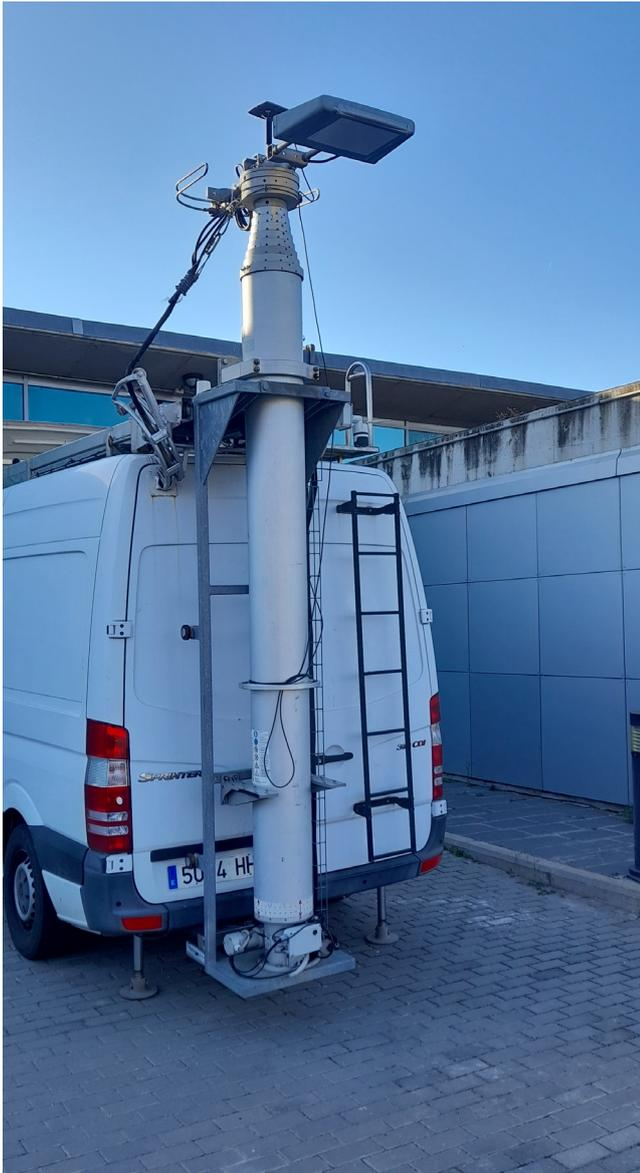
Figura 16. Calibración de sistema de ayuda en el aterrizaje ILS de aeronaves (imagen cortesía de Enaire)
