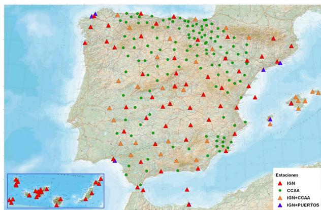
Figura 3. Distribución de las estaciones permanentes ERGNSS que proveen datos al SPTR
