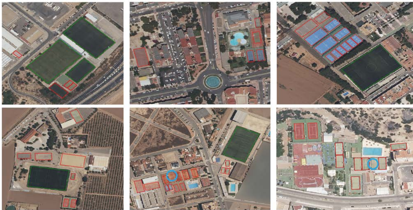
Figura 4. Seis ejemplos de distintos tipos de escenarios donde la red ha obtenido buenos resultados. Con contorno verde los campos de fútbol y con contorno rojo las pistas deportivas descubiertas. No hay falsos positivos y tan solo, en las dos últimas, hay un falso negativo en cada una (marcado en azul)
