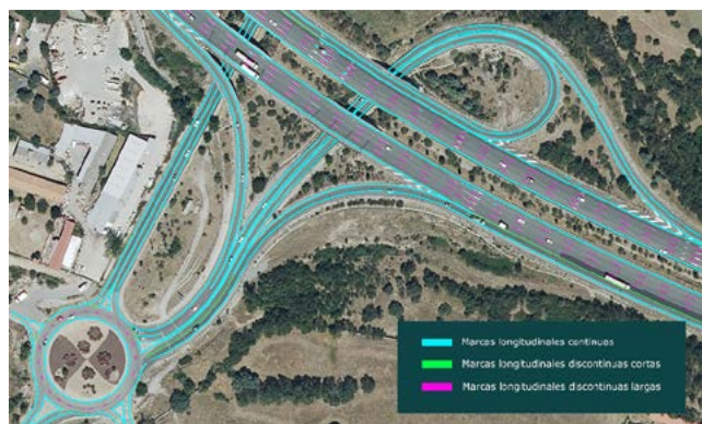
Figura 1. Resultado de la detección automática de marcas longitudinales. Proyecto RTAD.
