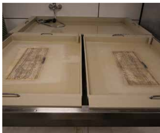
Figuras 16 y 17. Lavado del documento con agua protegido con el soporte de apoyo tejido no tejido.
