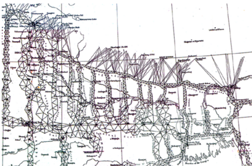
Figura 2. Detalle de la red de triangulación del Gran Levantamiento Trigonómico de la India en 1870 bajo la supervisión del superintendente James Thomas Walker. Fuente: Walker 1870.
