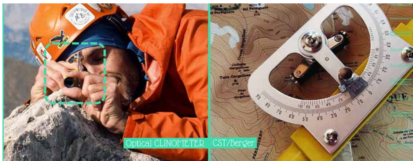
Figura 15. A la izquierda, Andreu Alvarruiz coteja el horizonte apoyando el clinómetro en el primer candidato a punto más alto de la cima. A la derecha, detalle del clinómetro donde se aprecia la regulación que permite conocer la diferencia angular con el punto visado. Fuente: Sostremetries 2025.
