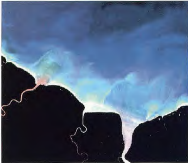
Figura 2a: Sub-imagen SPOT XS del 1ro de febrero de 1999, con dimensiones 30 x 40 km, después de estandarización de luz incidente, corrección de efectos atmosféricos y puesta de máscara de la parte terrestre
