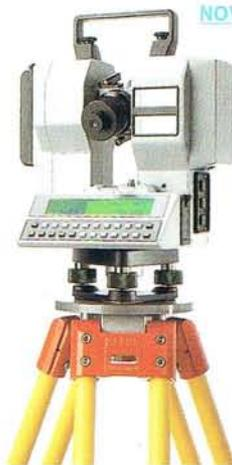
**NOVEDAD:** Taquímetro electrónico registrador Rec Elta
