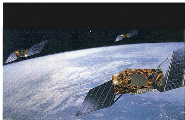
Los satélites orbitan a una altitud de 23222 kms, con un periodo orbital de 14 horas
