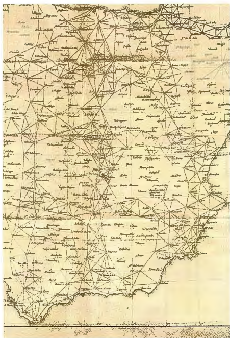
Fragmento de la Lámina VIII, con la triangulación geodésica de primer orden (Año 1870)
