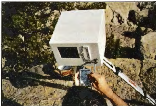
Imagen del láser escáner, con la PDA, que permite conectar con el equipo y modificar los parámetros.
