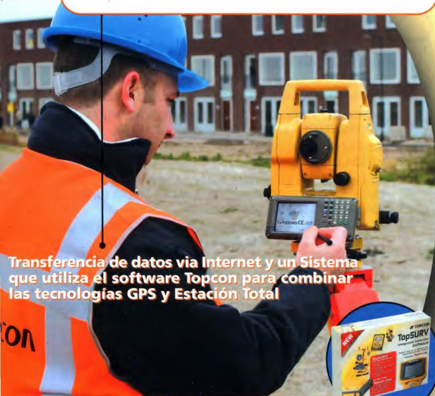
**Transferencia de datos via Internet y un Sistema que utiliza el software Topcon para combinar las tecnologías GPS y Estación Total**
