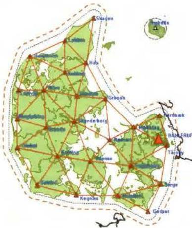
Red VRS en Dinamarca con GPSNet de Trimble <http://www.GPSNet.dk>
