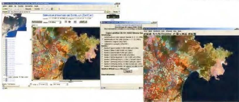
Servidor de Imágenes de Satélite (SatCat). Ejemplo de descarga de un MMZ con una combinación RGB de una capa vía WCS a partir de la previsualización del ámbito y la determinación de los parámetros específicos de la capa [9].
