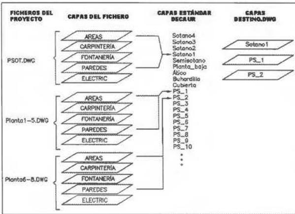
Figura 4: Copiado del contenido de las capas necesarias sobre capas estándar propuestas por la GRCV
