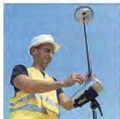
El nuevo **Leica SmartRover** es la solución GPS todo en el bastón más ligera del mundo y es totalmente compatible con el SmartStation, la primera estación total del mundo con el GPS integrado. Usa SmartStation para estacionar tu estación total y después cambia la SmartAntenna para continuar
