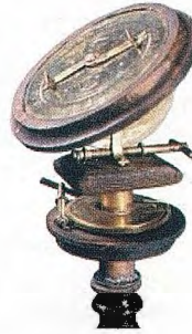
Reconstrucción de la dioptra, el más remoto antecedente del teodolito. El instrumento contaba con el llamado mediclinium , un vocablo que sería traducido al árabe y adoptado después por el castellano como alidada. A la derecha se representa una escuela de gladiadores, cerca del Coliseum, en un fragmento de la Forma Urbis Romae .
