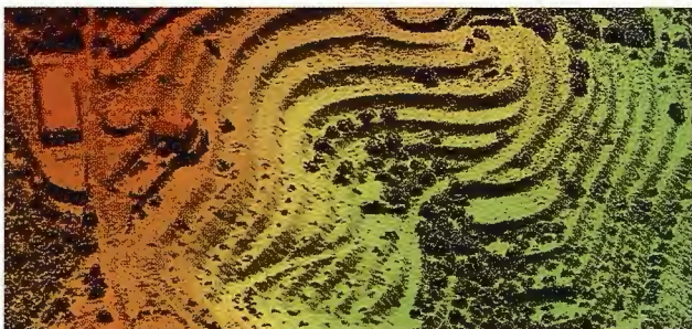
Vista isométrica de un Modelo Digital de Superficies de una zona abancalada en barrancos de Granada.
