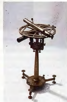
E. Lenoir y otro de los círculos repetidores que construyó de acuerdo con los diseños de Borda. El círculo se encuentra aquí en posición acimutal.
