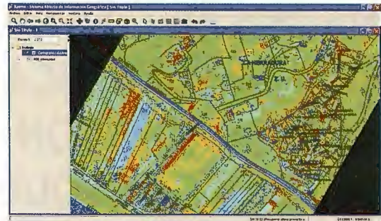
Combinación de datos de intensidad Lidar con cartografía del Catastro conectándose a su servidor WMS
