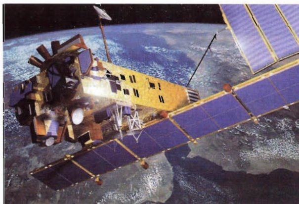
El mayor instrumento del ENVISAT es el Advanced Synthetic Aperture Radar, opera en la banda C, y asegura la continuidad de los datos obtenidos por el ERS-2. La inclinación de la órbita es de 98°. Orbita la Tierra en 101 minutos.
