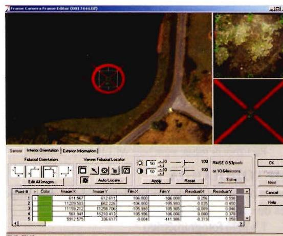
Fig.6 medición de marca fiducial
