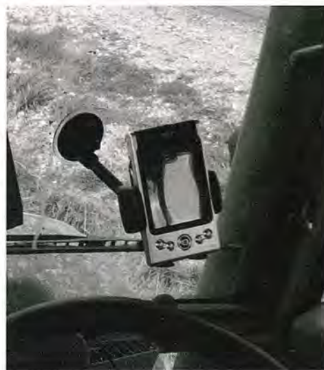
Figura 15: Instalación del Pocket-PC en el tractor mediante una ventosa de sujeción
