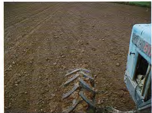
Figura 43: La distancia entre pasadas se mantiene de forma visual haciendo que la rueda circule por la marca.
