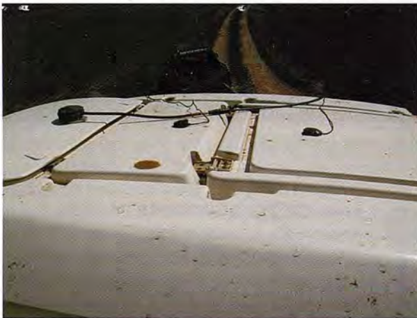
Figura 38: Posición de las antenas de los GPSs
