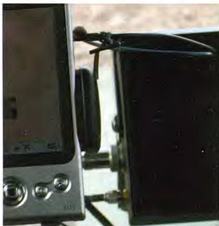
Figura 17: Detalle de la conexión del cable de antena al receptor GPS
