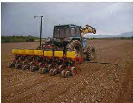
Figura 42: Sembradora con la que se realizaron las pruebas, que dispone de un marcador
