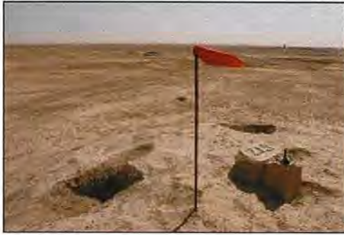
Figura 6. Navegador GPS situado en un punto junto a la bandera y sobre el pilar (abajo a la derecha).
