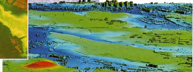
Aeropuerto de Pamplona. Modelo Digital de Superficie generado por LIDAR - Malla de 2x2m
