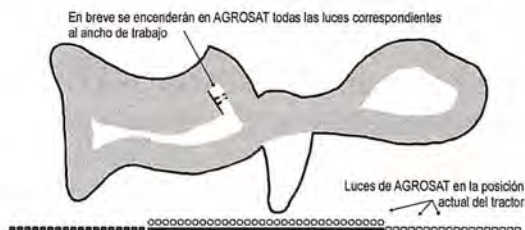
Figura 6: Separación excesiva del tractor con respecto a la pasada anterior.
