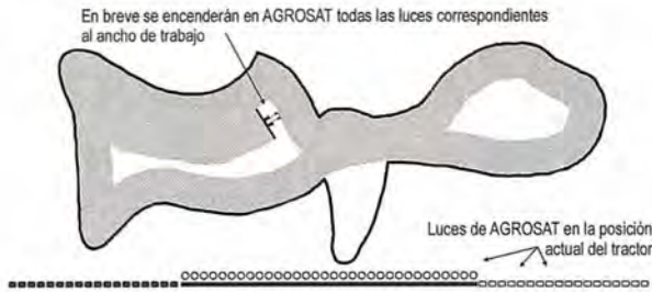
Figura 9: El tractorista realiza una segunda pasada haciendo coincidir el extremo izquierdo de su ancho de trabajo con el límite de la zona tratada en la pasada anterior. Todas las luces de AGROSAT fuera del ancho de trabajo en el extremo izquierdo están encendidas.
