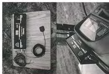
Figura 1: izquierda) Componentes de AGROSAT, derecha) AGROSAT instalado en el tractor.
