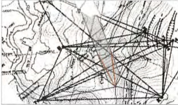
Establecimiento del sistema de bases de replanteo para un túnel
