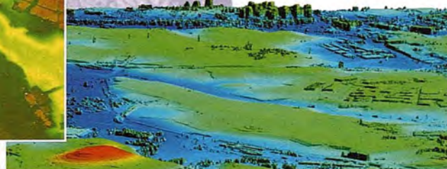
Aeropuerto de Pamplona. Modelo Digital de Superficie generado por LIDAR - Malla de 2x2m
