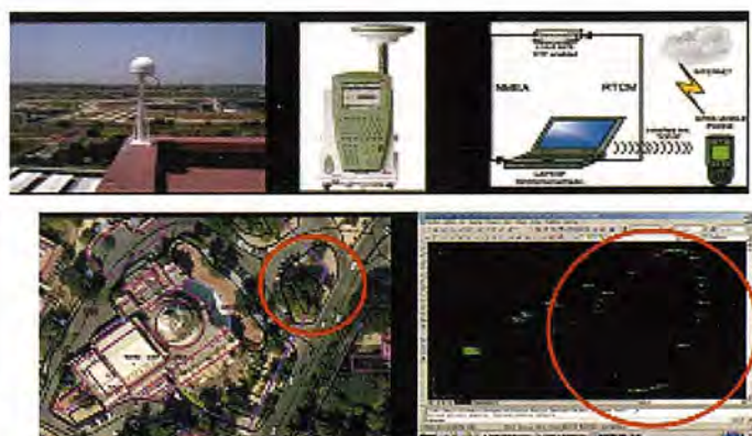
Fig. 2. Esquema de la instalación y distintos sistemas de envío de correcciones diferenciales
