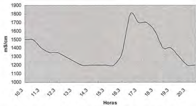
Fig. 24. Curva de paso del trazador durante el ensayo de 29/03/92
