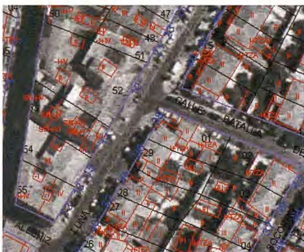
Figura 1: Ejemplo de alineación de datos vectoriales sobre ortoimagen
