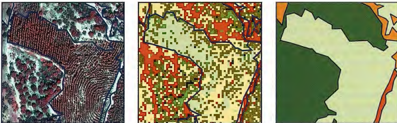
Fig. 2. No projecto CARFOR desenvolveu-se uma metodologia para cartografia automática de espécies florestais com base numa classificação espectral de imagens IKONOS ao nível do pixel e em segmentação da imagem para identificação de unidades de paisagem, seguidos da aplicação de regras de generalização para atribuição de uma classe temática a cada unidade de paisagem.
