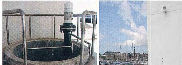
FIGURAS 32, 33 e 34 - Sensor, estação meteorológica e consola de registo e armazenamento de dados, do Marégrafo Acústico Digital
