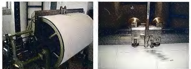
FIGURAS 24 e 25 - Pormenor do relógio e do tambor, evidenciando-se o pormenor da caneta que desenha as variações no nível da água
