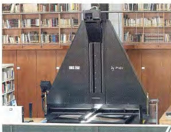
Figura 2: Equipo de digitalización Metis DRS2A0 del ICC, con capacidad para digitalizar originales de hasta 120x180 cm a 300 ppi.
