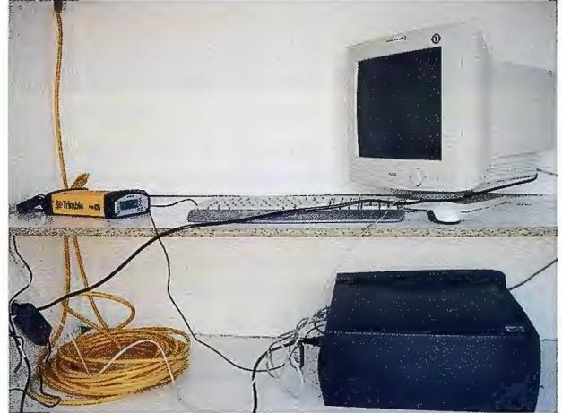
FIGURA 7. CENTRO RECEPCIÓN DE DATOS DE ESTACION DE REFERENCIA GNSS: UBICACIÓN: BOIRO (A CORUÑA)
