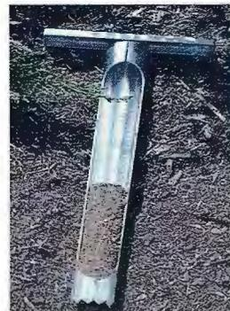
Figura 5. Hand Auger, recogedor de muestras del suelo contaminado.
