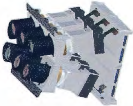
Figura 1: Sistema óptico de DEIMOS-1
