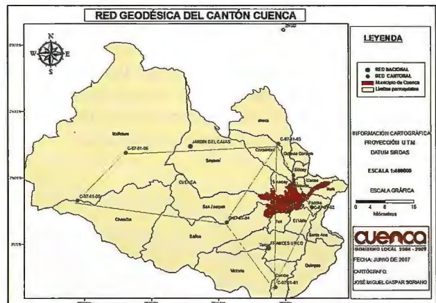
Figura 2. Mapa donde se aprecia la distribución de los puntos que forma la Red Geodésica del Cantón Cuenca, y los puntos pertenecientes a la Red GPS Nacional.
