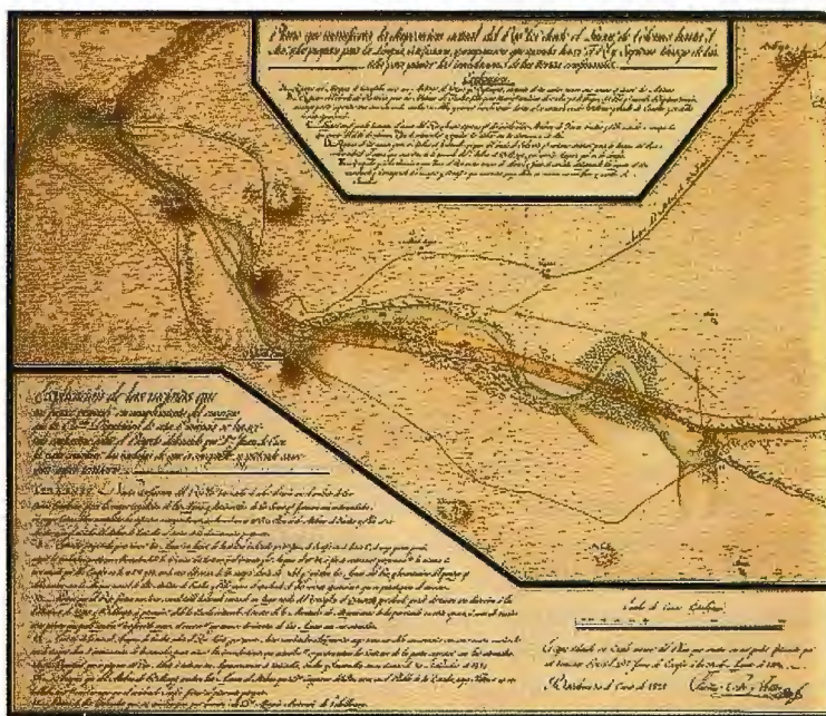
Figura 8. Detalle del proyecto de encauzamiento del río Ter en su tramo final, elaborado por Escofet en 1790. La copia del mapa es de 1821 (MOPU, 1985, nº 444)
