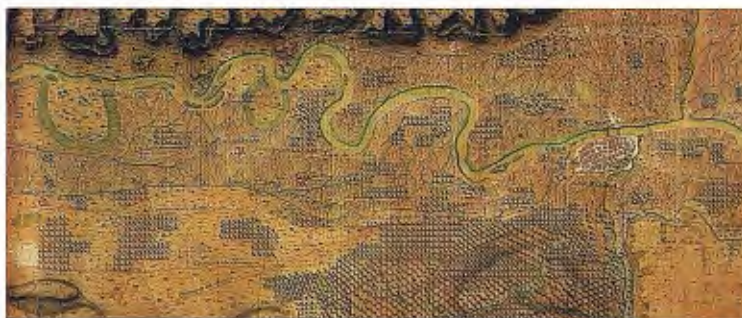
Figura 3. Detalle de un plano del Canal Imperial de Aragón junto al río Ebro (1746), entre Sobradriel y Zaragoza (MOPU, 1985, nº 21). Se combinan meandros con cortas de canal de crecida ( chutte cut-off ) y de cuello ( neck cut-off ), brazos y depósitos de sedimentos asociados al cauce. Todavía se puede observar el meandro de Juslibol, actualmente convertido en un galacho.
