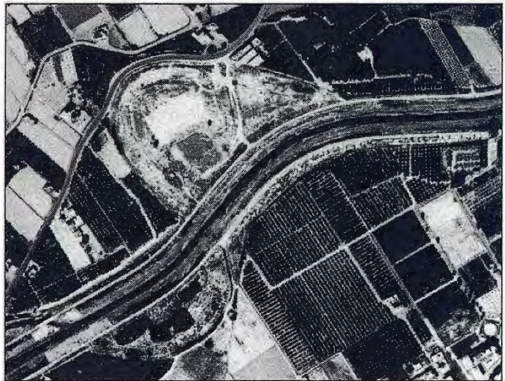
Figura 5. Meandro del camino de Beniel (1760) en el río Segura, y su situación actual tras las obras de encauzamiento realizadas en la década de 1990. (ARV. M y P nº 89 y ortofoto del SIG Oleícola)
