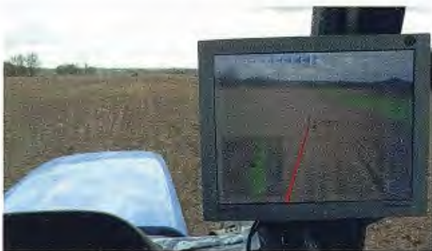
Figura 6-4: Captura de la aplicación en uso. Podemos ver el error que se está cometiendo, y se nos indica que debemos corregirlo girando hacia la izquierda. Las zonas tratadas aparecen en verde.
