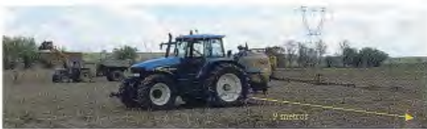
Figura 6-3: Tractor usado en las pruebas de campo, equipado con un apero de 18 metros. En la imagen se aprecian 9 metros del apero.
