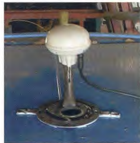
Figura 4-1: Receptor GPS Novatel Smart Antenna V1, usado en el proyecto.
