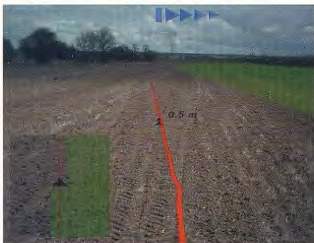
Figura 6-9: Capturación de la aplicación de realidad aumentada cuando el tractorista realiza la pasada en la que tiene un pequeño error de trazada hacia la derecha, y deja terreno sin tratar. En la pantalla se indica que el error es 0.5 metros.
