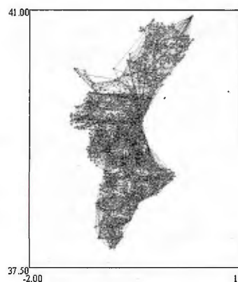
Figuras 4 y 5: Red Geodésica de Cuarto Orden del ICV y Modelo de Geoides GECV07 para la Comunidad Valenciana. Elipsoide de referencia GRS80
