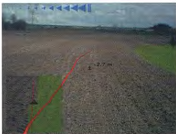
Figura 6-10: Capturación de la aplicación de realidad aumentada cuando el tractorista realiza la pasada en la que tiene un error de trazada hacia la izquierda, y está pasando por terreno tratado. En la pantalla se indica que el error es -2.7 metros, al ser negativo nos indica solapamiento entre pasadas.
