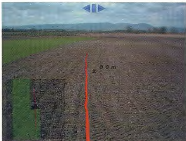
Figura 6-8: Capturación de la aplicación de realidad aumentada cuando el tractorista realiza la pasada de forma correcta. En la pantalla se indica que el error es 0.0 metros.
