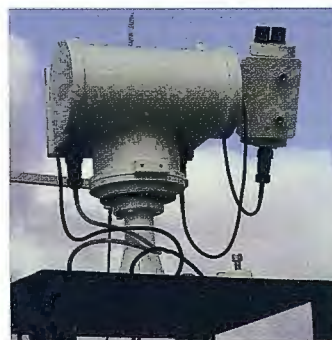
Fig.2: Sky scanner EKO dispuesto de dos sensores para medir radiancia y luminancia (izquierda) y diagramas de la distribución en los diferentes sectores de medidas de luminancia (centro) y radiancia (derecha).
