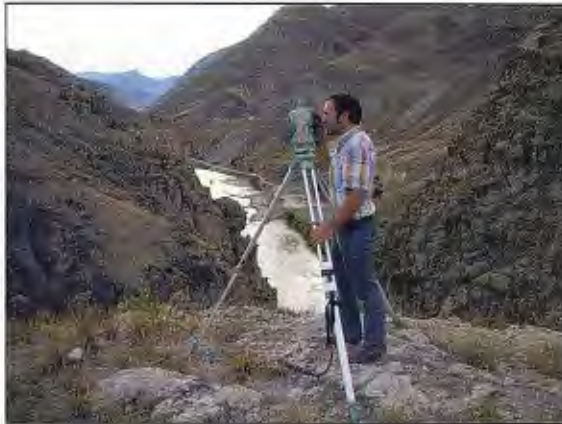
Figura 12. Operario realizando el levantamiento topográfico con Estación Total y Modelo Digital del Terreno correspondiente a la Zona C.
