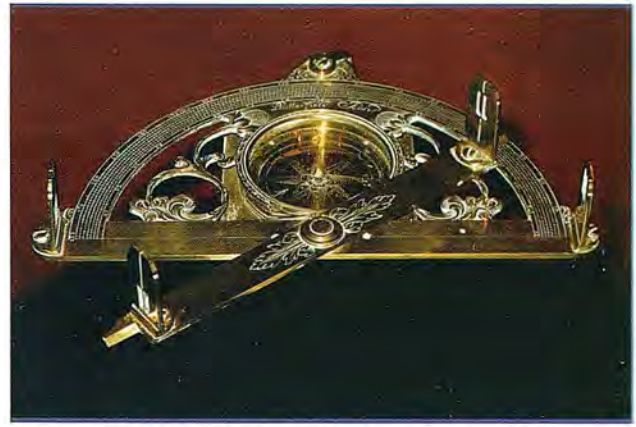
Fig 13 Grafómetro con brújula incorporada, similar al empleado por Inoh Tadataka. La alidada móvil lleva en sus extremos los elementos de puntería, idénticos a los que figuran en la base del semicírculo graduado
