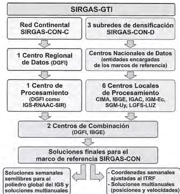
Fig. 3. Esquema de procesamiento de la red SIRGAS-CON (red continental + redes de densificación)
