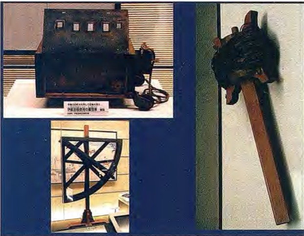
Fig 12. Instrumentos usados durante los levantamientos: Podómetro, Cuadrante y Cuerda. Ino Tadataka Memorial Museum
