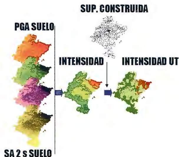
Figura 7. Esquema del módulo de Intensidad Macrosísmica EMS-98
