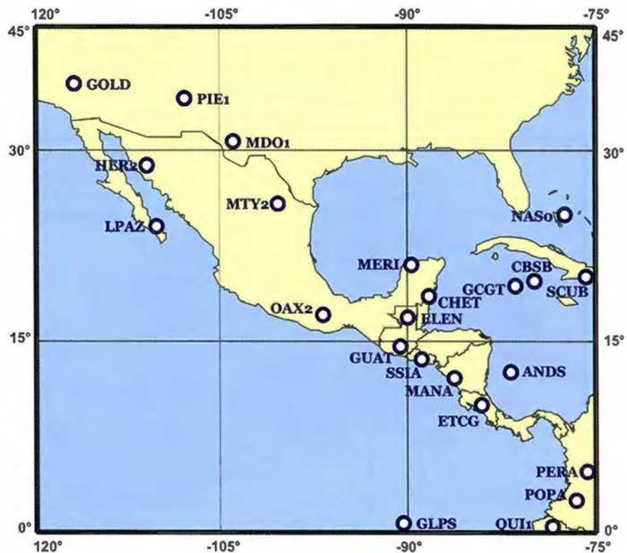
Figura 2. Estaciones SIRGAS-CON incluidas en el procesamiento de la Red Geodésica Básica Nacional de El Salvador (SIRGAS-ES2007). Las estaciones GOLD, PIE1, MDO1, ELEN, GUAT, SSIA, MANA, SCUB, GLPS, QUI1 también están incluidas en la red global del IGS.
