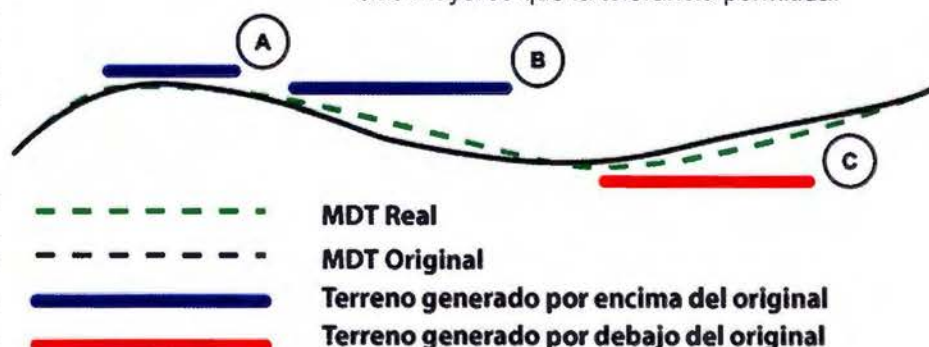
Figura 1. Relación entre perfil real, original y detectado del terreno.
