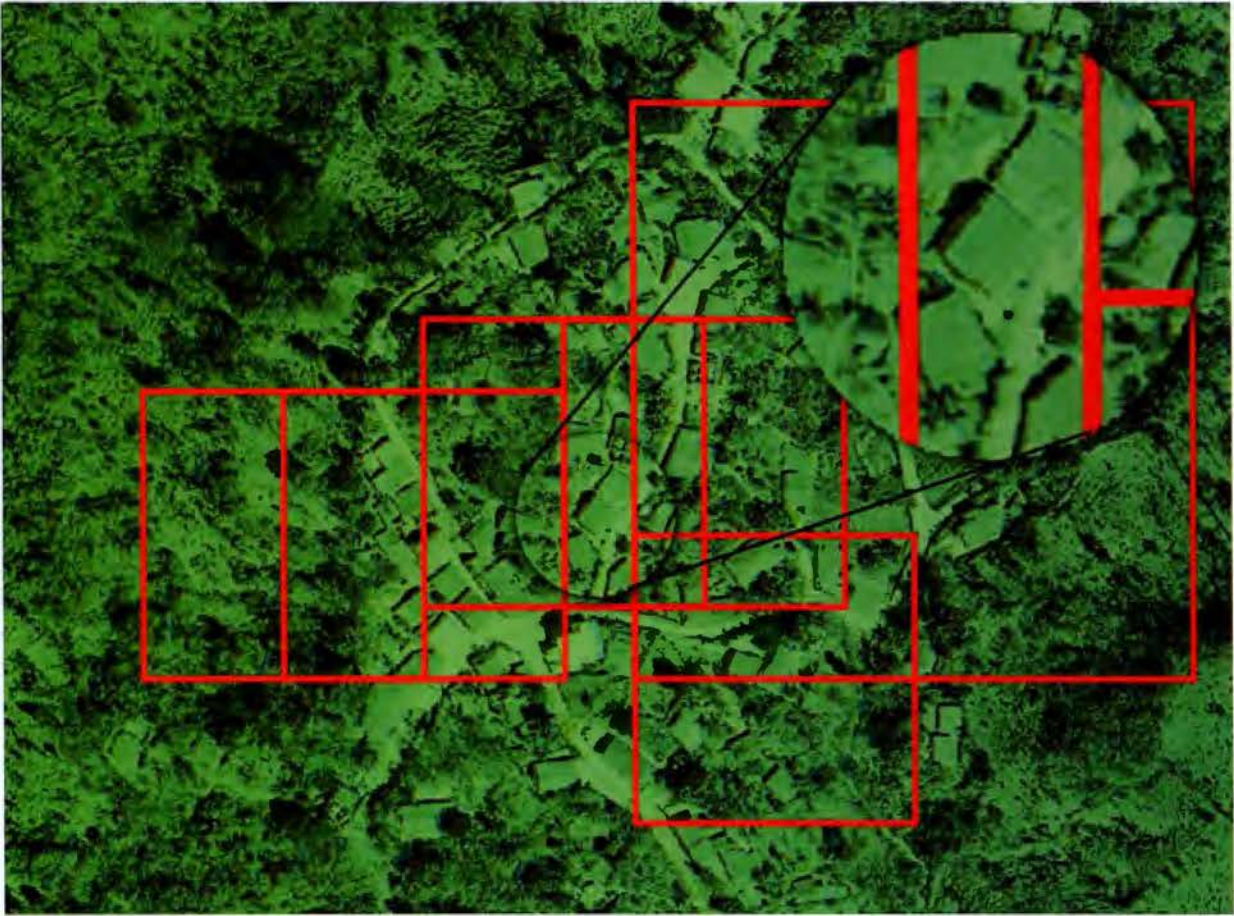
Figura 15. Detección visual de diferencias mediante efecto cromático. En este caso las diferencias no son debidas a desplazamientos si no a utilizar diferentes fotos, apreciándose coloreadas las partes altas
