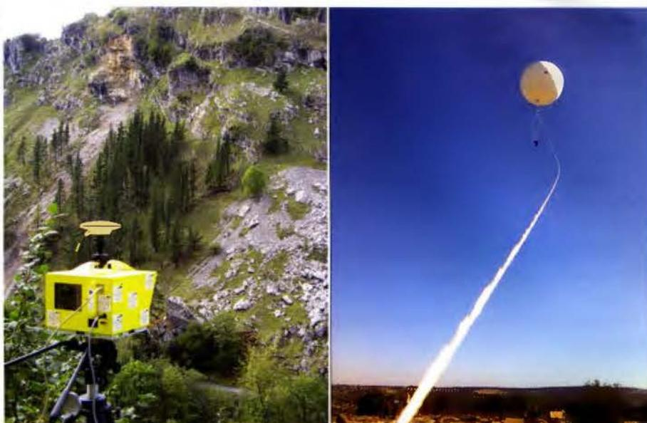
Figura 1. A: LIDAR terrestre Optech empleado en el estudio de deformaciones del terreno (valle del río Miera, Cantabria). B: Fotogrametría aérea desde globo de helio para levantamientos arqueológicos
