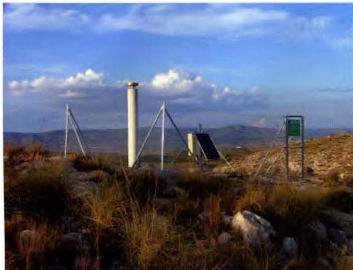
Figura 7. Estación permanente GPS del Proyecto Topo-Iberia
