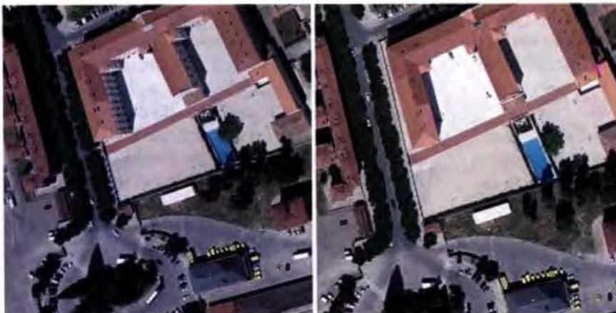
Figura 9. Ejemplo de Orto-Rectificación Verdadera con la solución Altai-LRTO
