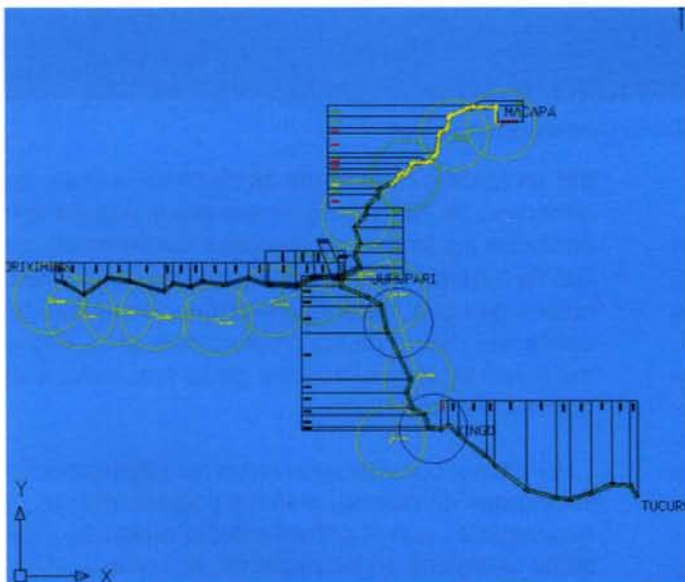
Figura 2. Gráfico de Distribución de Pasadas y Base de control de Tierra
