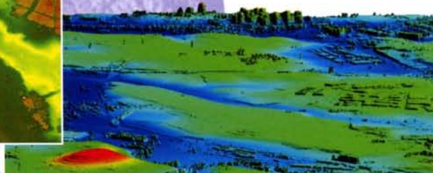
Aeropuerto de Pamplona. Modelo Digital de Superficie generado por LIDAR - Malla de 2x2m
