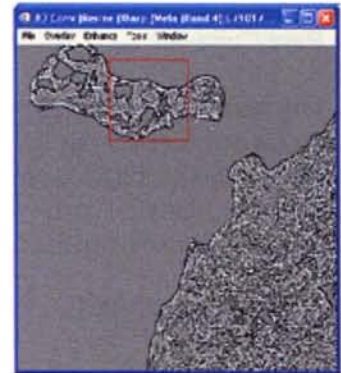
Fig. 3. Ejemplo de Filtro espacial, pasa alto en la banda 4
