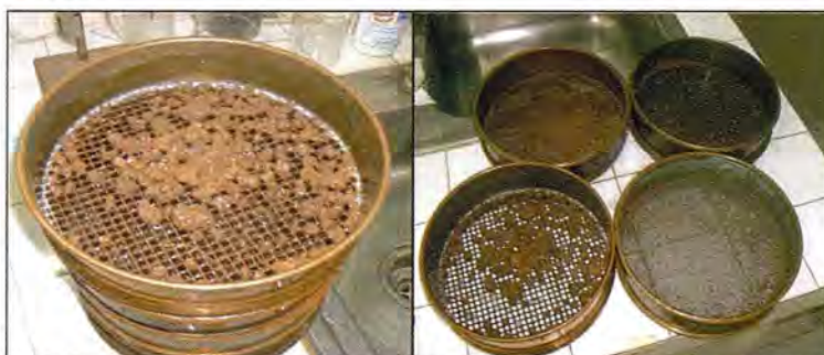
Figura 3. Tamices con muestra escurriéndose
