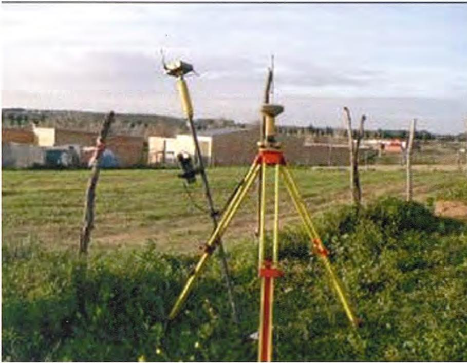
Figura 4: Los dos equipos GPS
