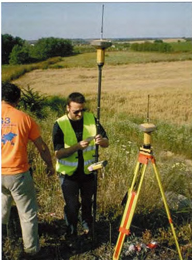
Figura 2: Estacionamiento de las bases
