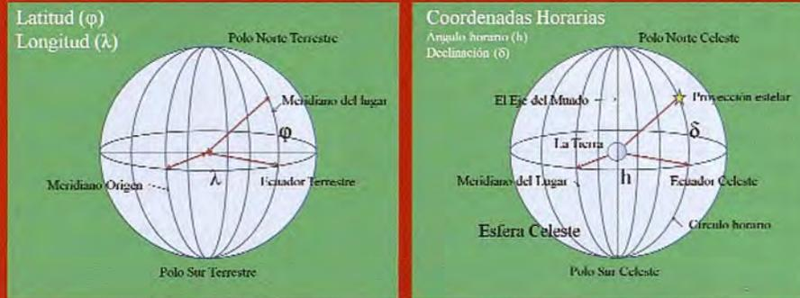
Figura 3. Coincidencia entre la diferencia de longitudes y la diferencia de ángulos horarios (horas locales).
