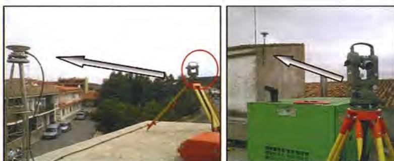
Figuras 8 y 9: Transferencia de desnivel y observación de la nivelación trigonométrica
