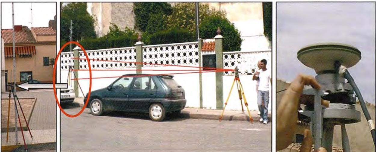
Figuras 6 y 7. -Ejemplo de transferencia de desnivel con mira milimétrica y con "pie de rey"
