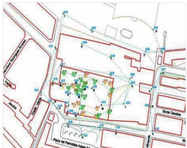
Figura 9. Red de Control Métrico (RCM).
