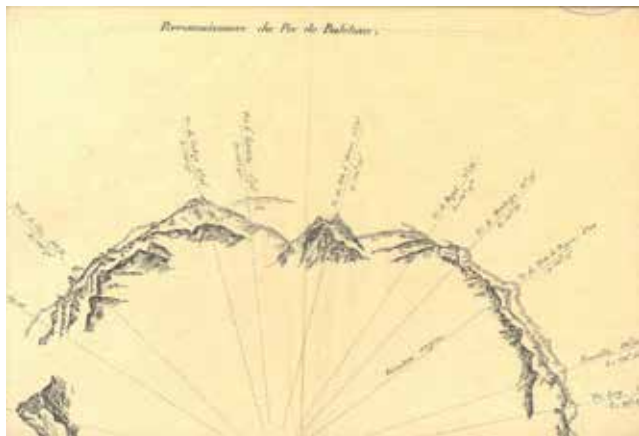
Figura 5. Reconnaissance du Pic de Baletous. Vuelta de horizonte con identificación de las visuales. Observadores: Peytier et Hossard. 1826.
