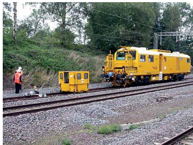
Figura 8. Vehículo de control, modelo Plasser&Theurer. Fuente: http://www.plasser.co.uk/
