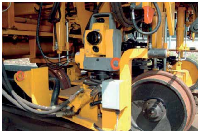
Figura 9. Lector de piquetes en modelo em-sat plasser&theurer. Fuente: http://www.plassertheurer.com/es/
