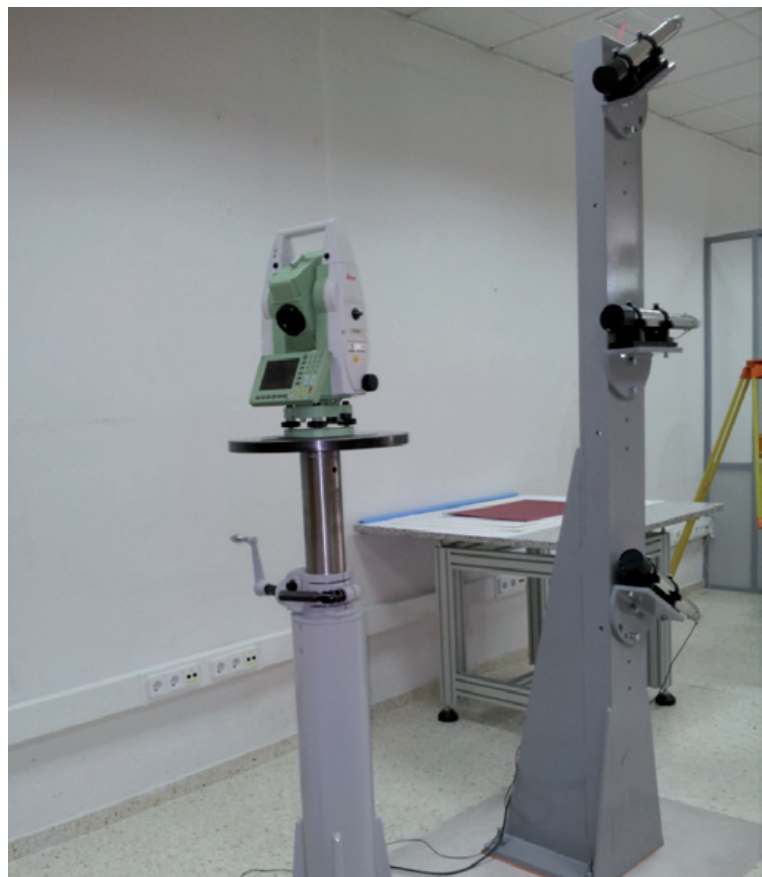
Figura 1. Conjunto de colimadores para la calibración de ángulos horizontales y verticales
