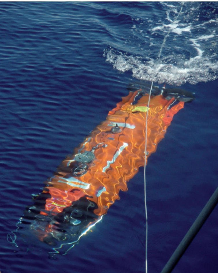
Figura 4. Vehículo submarino guiado Pluto Plus para la identificación de objetos submarinos
