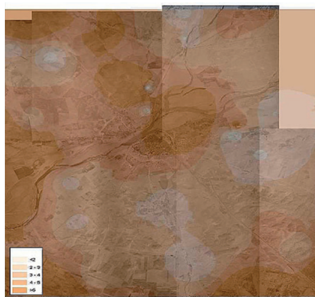
Figura 11. Modelado del error planimétrico en la ortofotografía de 1946 con puntos de muestreo
