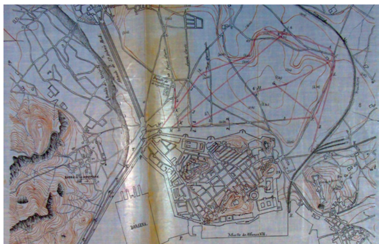
Figura 5. Plano de avenamiento del proyecto de Ensanche, reforma y saneamiento de Cartagena (Ramos, García y Oliver, 1896)
